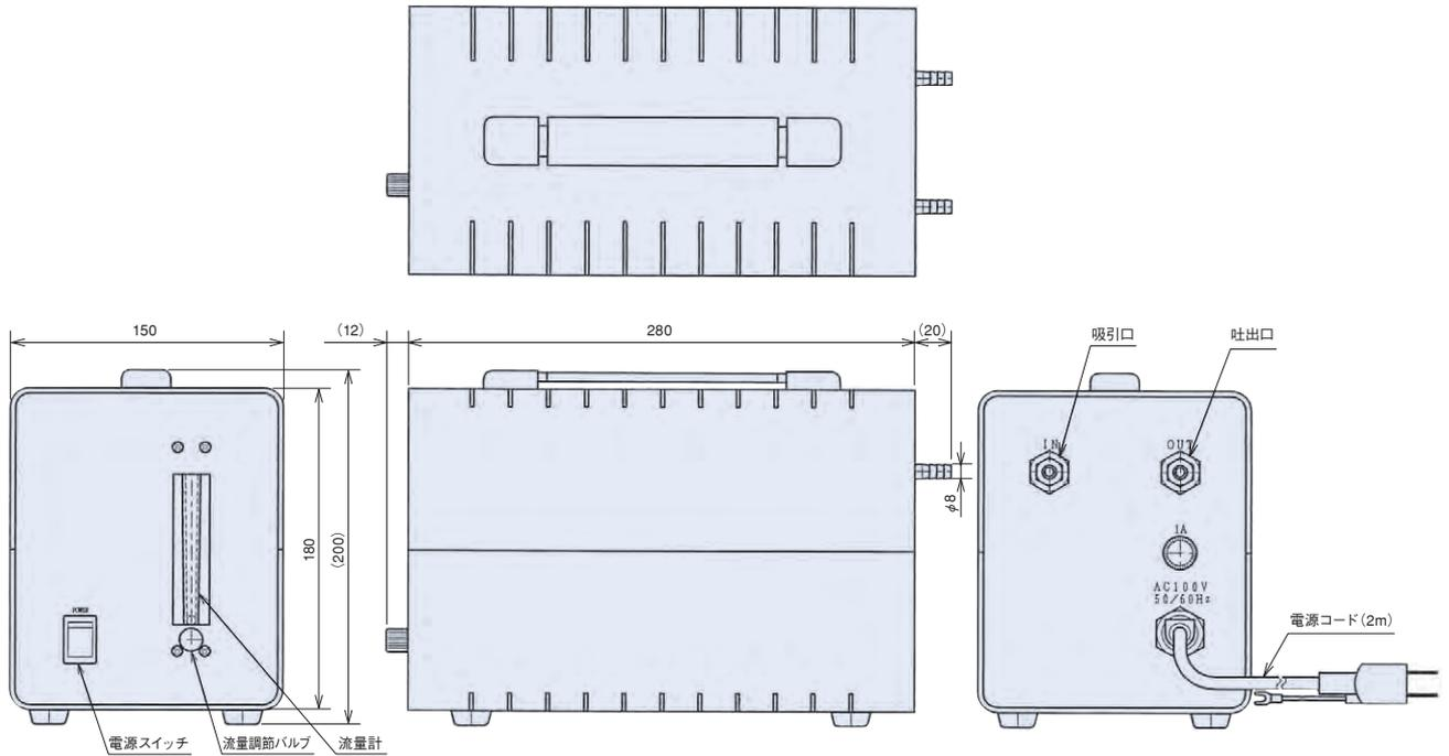
ダスト・ダイオキシン類・粒子状水銀などの採取に最適な吸引ポンプもございます。
