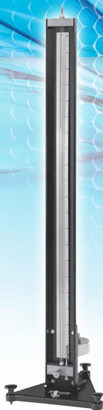
本製品はU字型の片方の径を大きくすることにより液柱差の読取を1本のゲージで行う単管式のマンメータです。
